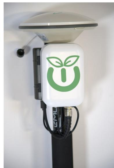
Assurez-vous que l'antenne GPS est connectée au convertisseur GNSS avec le câble d'antenne GPS, et que le convertisseur GNSS est connecté à la batterie mobile avec le câble USB à USB-C. L'indicateur led de la batterie mobile peut montrer le niveau de charge.
