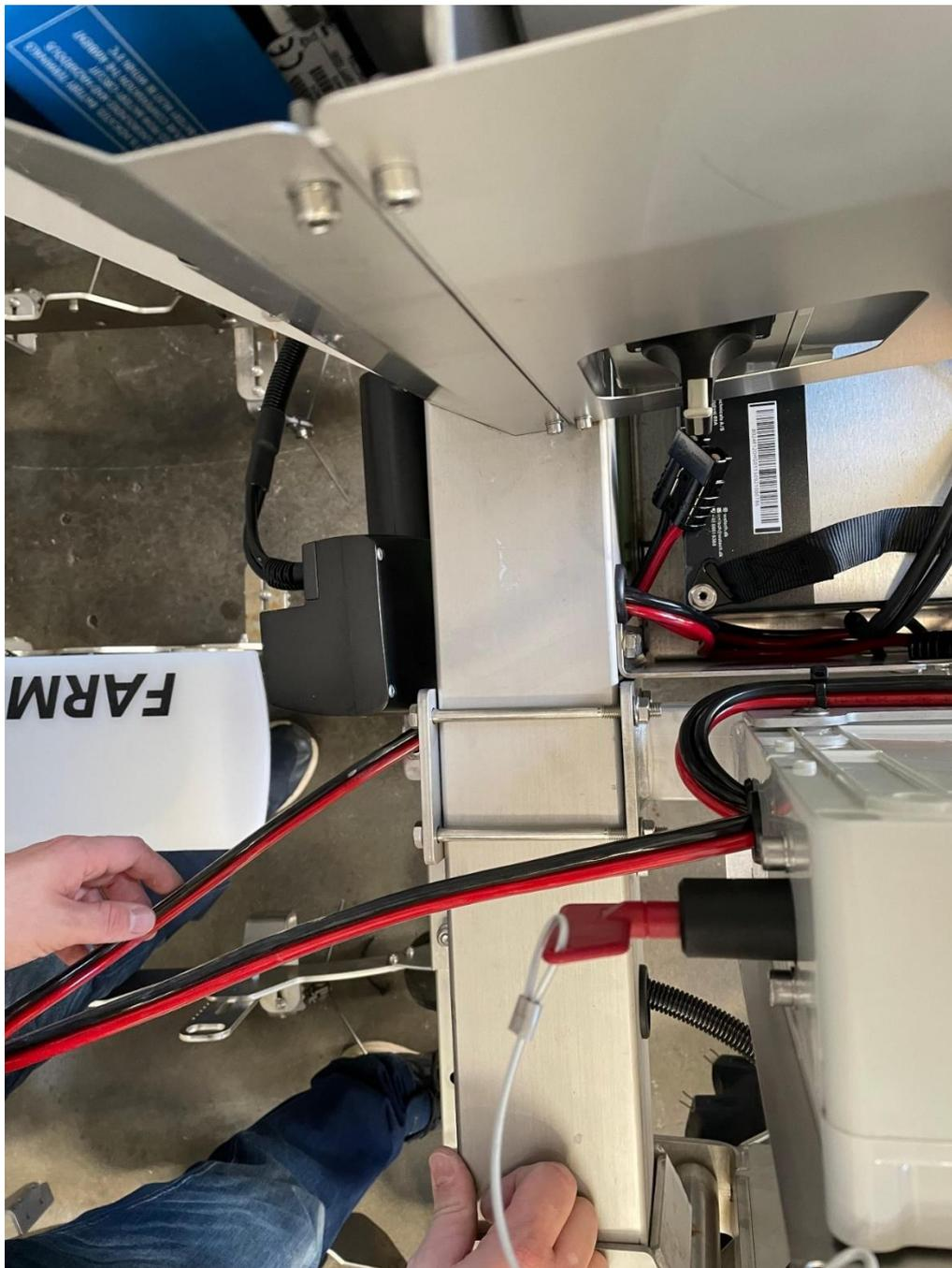
18. Das Kabel in den vorhandenen Stecker, der sich auf der linken Seite des Batteriegehäuses befindet, stecken
