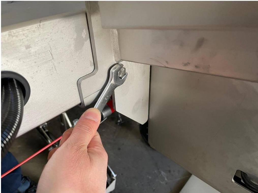
13. Den Aktuator mit der neuen Halterung am Rahmen befestigen. Die Muttern fest anziehen.
