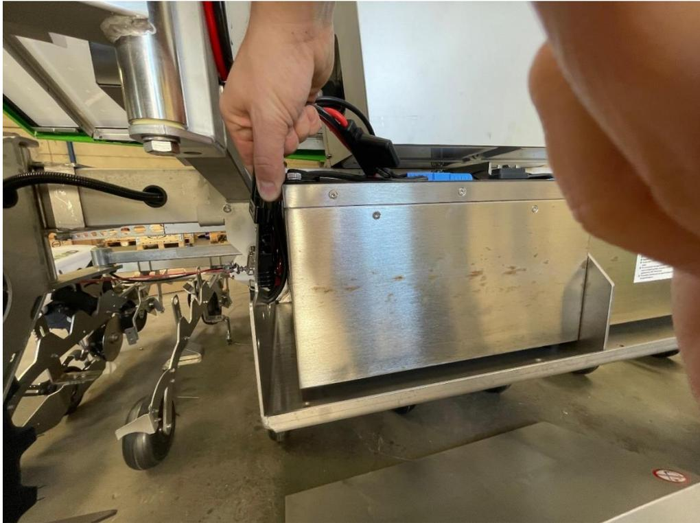
19. Das Gehäuse der Powerbank schwenken, um es zu schließen.
