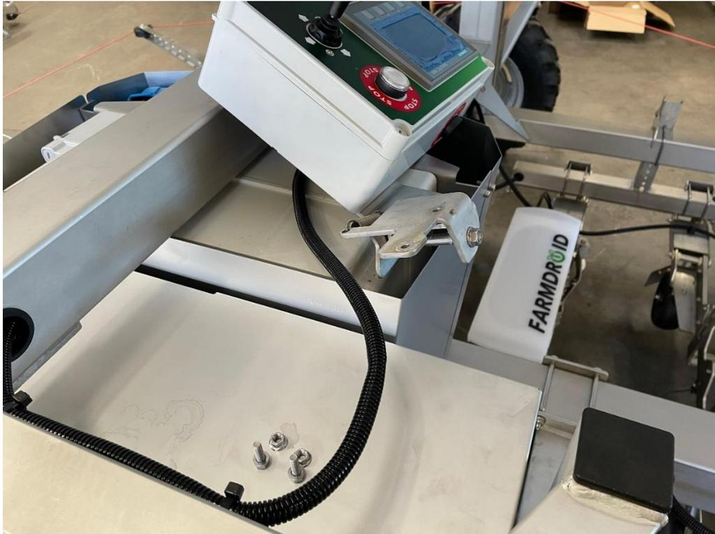
7. Die seitliche Halterung der Powerbank am oberen Teil des Rahmens befestigen.
