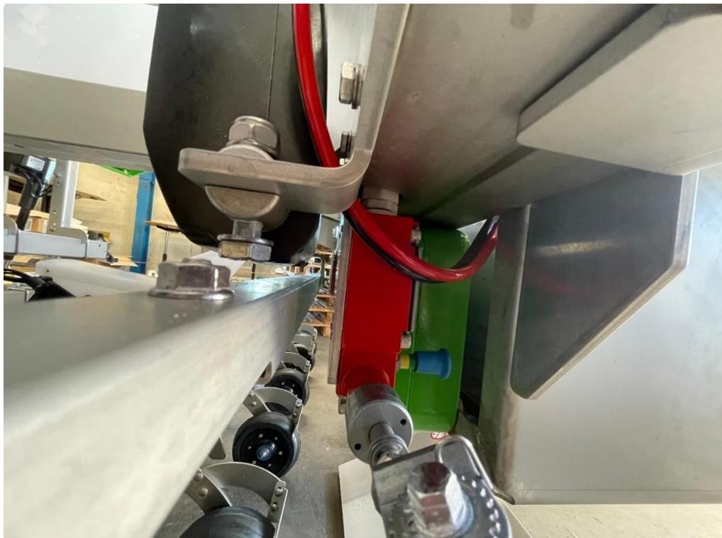
17. Und schließlich muss das Kabel im Batteriegehäuse unter der Schalttafel angelangen
