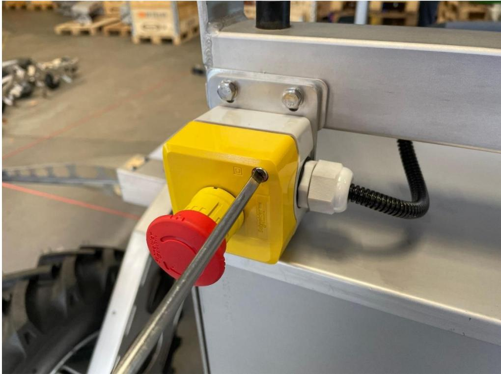
23. So sieht eine korrekte Installation aus. Bitte beachten, wo die Kabel der Batterien befestigt sind!
