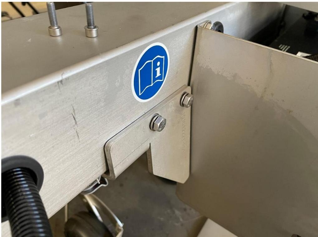
3. Die alte Schalttafelabdeckung entfernen und durch die neue Abdeckung, die im Bausatz enthalten ist, ersetzen.
