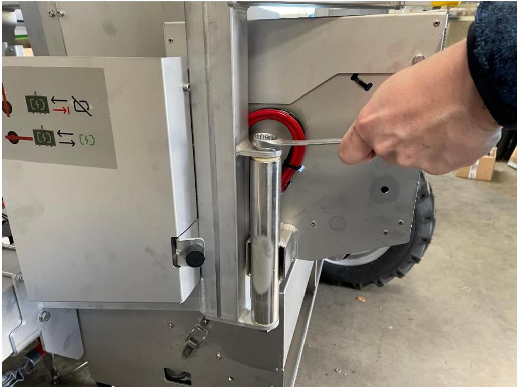
21. Nun die Installation des HMI abschließen, indem es mit einem 10-mm-Schlüssel an der neuen Halterung befestigt wird.
