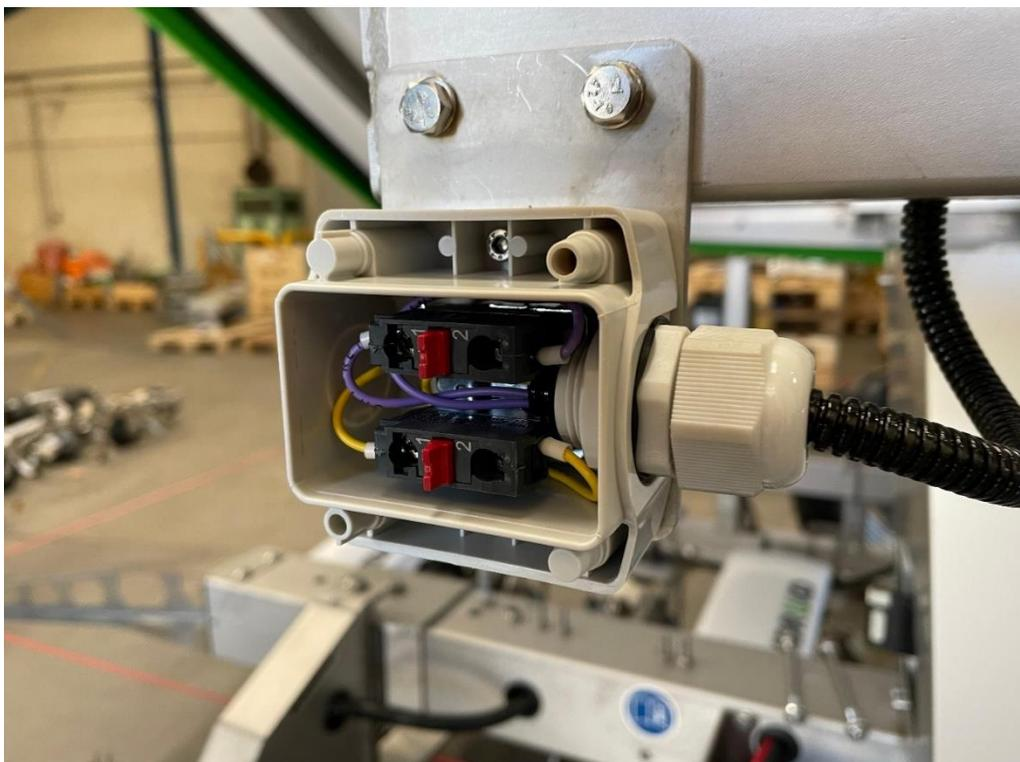
5. Auf der rechten Seite des Roboters die Kabelbinder durchschneiden und ungefähr 15 cm des Kabels, das zum HMI führt, durchziehen. Das verlängerte Kabel mit zwei Kabelbindern befestigen.
