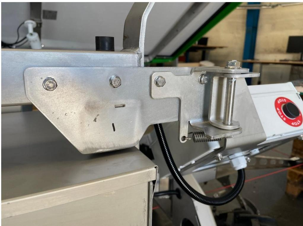
22. Den Not-Aus-Knopf zuerst mit dem 3-mm-Inbusschlüssel befestigen und dann mit einem Schraubendreher.
