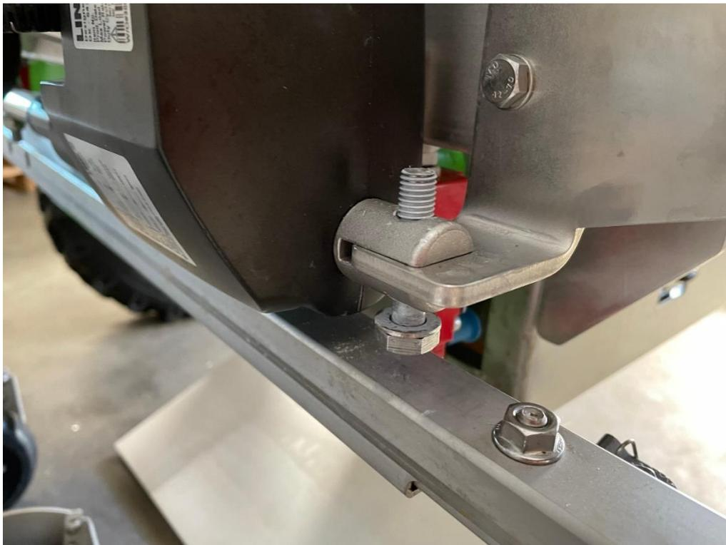
14. Die linke Halterung der Powerbank mit 5 Schrauben am Rahmen befestigen. Darauf achten, die Muttern festzuziehen.
